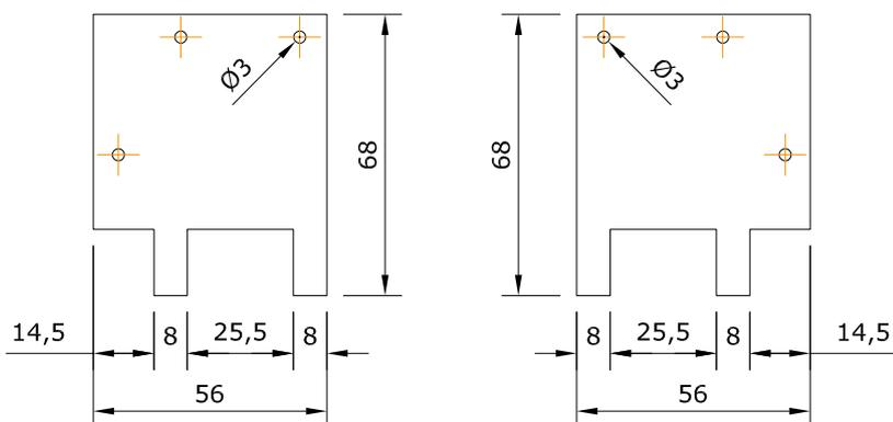
**PASO 11.** Colocar las tapetas centrales al perfil NT10-2190 mediante los tornillo D7982PH3,9 x 9,5 negras (incluidos en el kit NA10-1090).
