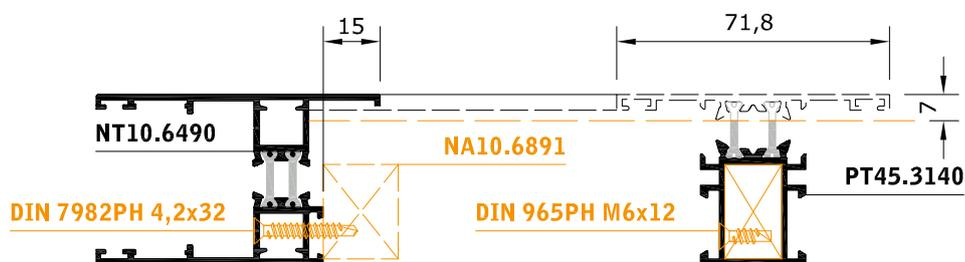
UNIÓN MEDIANTE TORNILLOS
