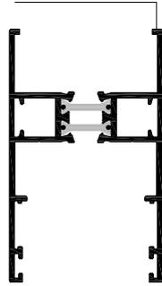
**PASO 1.** Corte perfiles NT10-6490, NT10-6890; NT10-6199 y NT10-6299 a 45 grados.
