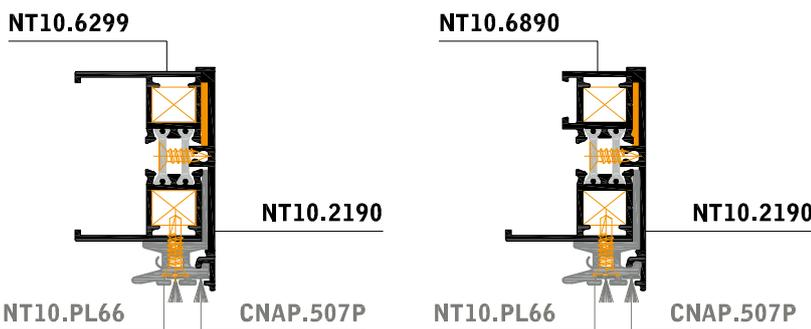
**PASO 9.** Colocación de la felpa BI-FIN **CNAP-507P** en los dos carriles del perfil NT10-PL66.
