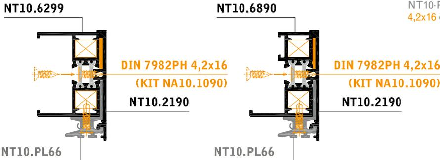
**PASO 8.** Fijación mecánica del perfil NT10-2190 con NT10-PL66 y NT10-6890 mediante tornillos **D7982 PH 4,2x16** (incluidos en el Kit de ensamble NT10-1090).
