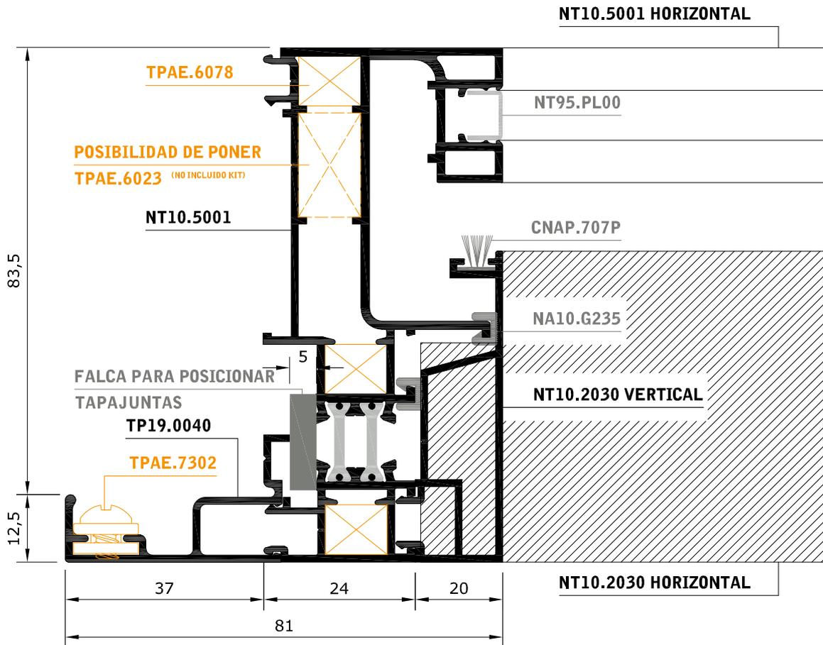
**MECANIZADO EN TRAVESAÑOS PARA LA UTILIZACIÓN DE FIJOS EN SERIE NEXUS 100RPT**
