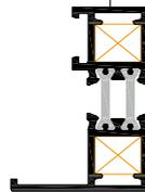
**PASO 4.** Ensamblar perfil NT10-6199 con NT10-6299 o NT10-6490 con NT10-6890 mediante escuadras de trabajo TPAE-6878.
