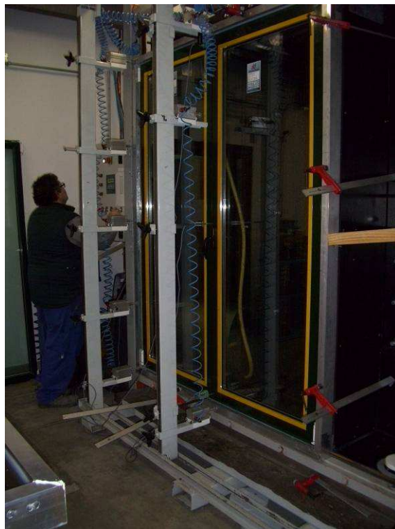
Foto N°.7. Detalle de la posición de los transductores.
