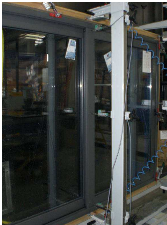
Foto N°6. Detalle de la posición de los transductores.
