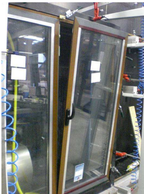
Foto N°.2. Detalle de apertura oscilobatiente.
