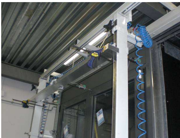
Foto N°.9. Detalle de la posición de los transductores.
